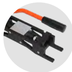
M0303 Pákový magnetický lis pro vlnité trubky DN8, DN12, DN15, DN20, DN25
